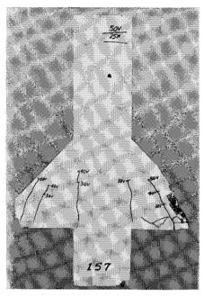
Fig. 22—Corbel End Failure (CE), H/V == 1
